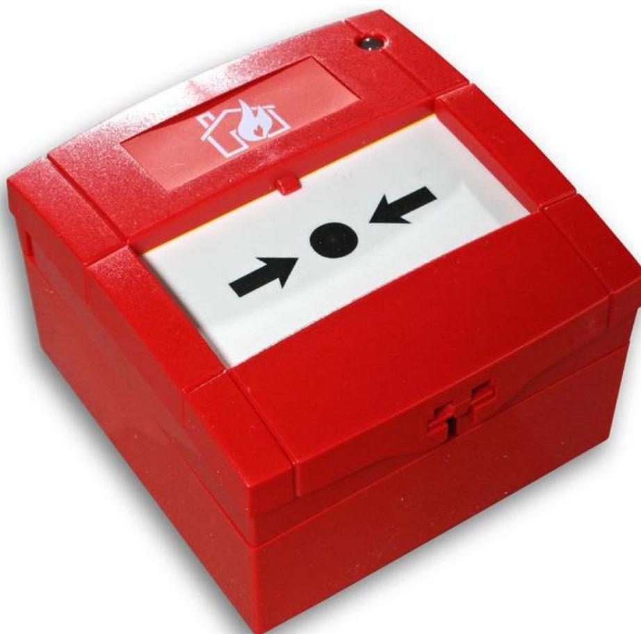
Le déclencheur manuel d'incendie Ei407 est un bouton d'urgence qui envoie un signal radio fréquence dès qu'une pression est exercée sur le repère noir. Ce signal d'alarme activera tous les avertisseurs incendie Radiolink du système avisant ainsi les occupants de l'immeuble d'un danger.
