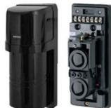
Capteur photoélectrique infrarouge actif à double rayon • Portée : 100m • LED de signalisation de l'état du système • Une excellente immunité aux radiofréquences • Sortie d'alarme • Sortie d'altération • Tension d'alimentation : 10 ±18 Vdc • Courant : < 43 mA • Classement de la protection des affaires : IP54
