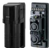
Capteur photoélectrique infrarouge actif à double rayon • Portée : 60m • LED de signalisation de l'état du système • Une excellente immunité aux radiofréquences • Sortie d'alarme • Sortie d'altération • Tension d'alimentation : 10 ÷ 18 Vdc • Courant : < 43 mA • Classement de la protection des affaires : IP54
