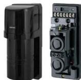
Capteur photoélectrique infrarouge actif à double rayon • Portée : 60m • LED de signalisation de l'état du système • Une excellente immunité aux radiofréquences • Sortie d'alarme • Sortie d'altération • Tension d'alimentation : 10 ±18 Vdc • Courant : < 43 mA • Classement de la protection des affaires : IP54
