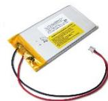
Batterie lithium, autonomie 6h, 3.7v 2.6ah, pour ble320 & bgs220
