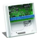
**M-IN/OUT** • module d'Extension d'Entrées/Sorties • Peut fonctionner comme: Extension d'Entrées à 6 Zones; Extension de Sorties à 6 Sorties; Extension d'Entrées/Sorties, à 4 Zones et 2 Sorties; Extension d'Entrées/Sorties, à 2 Zones et 4 Sorties. • Consommation : 20 mA • Dimension (LxHxE) 108 x 101 x 34mm
