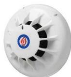
702H (température fixe) détectent les températures anormalement élevées au-dessus de 60 degrés. • CARACTÉRISTIQUES : • EN54 Approuvé par le LPCB • Basse tension de fonctionnement : 10,5 Vdc à 33 Vdc • Esthétiquement discret • Des performances et une fiabilité supérieures • Conçu pour une installation rapide • LED d'alarme intégrée • Connexion pour LED distante • Câblage indépendant de la polarité • Compatible avec le socle de montage standard et avec le socle à relais
