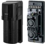
Capteur photoélectrique infrarouge actif à double rayon • Portée : 100m • LED de signalisation de l'état du système • Une excellente immunité aux radiofréquences • Sortie d'alarme • Sortie d'altération • Tension d'alimentation : 10 ÷ 18 Vdc • Courant : < 43 mA • Classement de la protection des affaires : IP54
