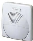
Tension de fonctionnement 12 Vdc • Consommation du Haut-Parleur (valeur moyenne) 90 mA • Volume sonore 104 dBA  $\pm$  3 dB @ 1 m • Taille (LxHxP): 126x132x53 mm • Classe de protection IP31 • Température de fonctionnement 5  $\div$  40 ° C
