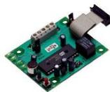
NC2VOX • synthèse vocale pour Kyo (sauf 100, 300 et 320) • 8 messages vocaux • 90 secondes • micro & HP intégrés • Possibilité de déporter micro et HP (max. 3) • Vérification audio "FULL DUPLEX" & Gestion à distance par téléphone
