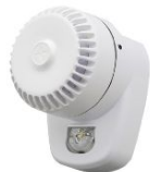
Sirène Roshni blanc avec flash led blanc pour montage mural, 32 tonalités, 102dB, 18-28VDC, 22-37 mA, IP65, conforme EN54-3 et EN54-23, couverture flash W-2,4-7,5, fréquence 0,5 ou 1 Hz, L95mm x H135mm x P95mm.
